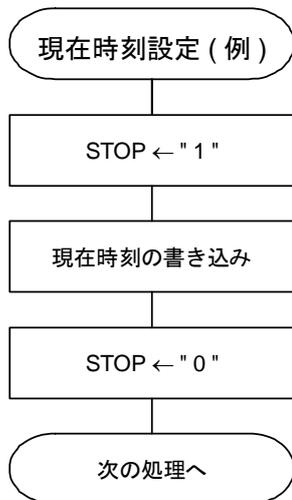
• STOP ビットを "1" にし、時刻設定中の計時更新を事前防止します。
