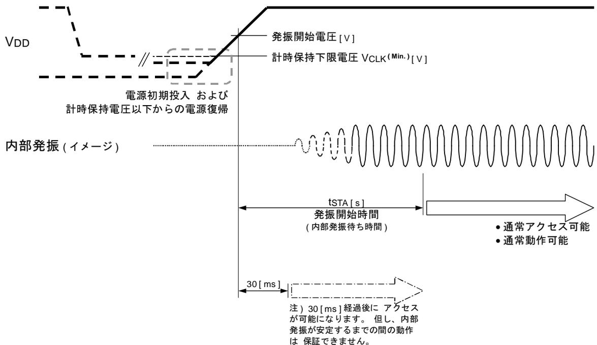
3) VLF-bit の読み出し結果が VLF = " 0 ( 正常状態 ) " のときのみ、発振開始時間を待たずに アクセス可能です。
