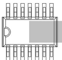
※網掛部分( )には信号線を接近させず、可能であれば GND パターンで埋めてください。
