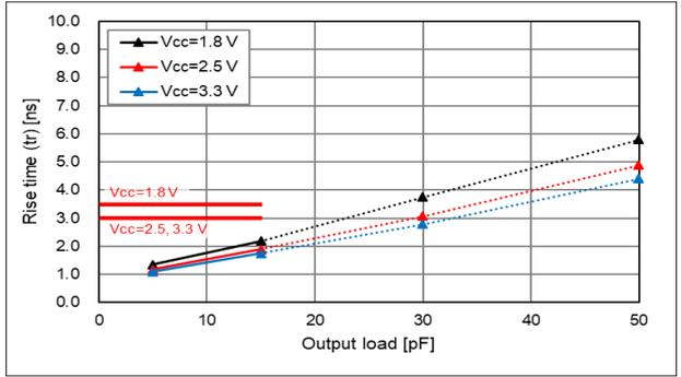
10% - 90% V<sub>CC</sub>, L<sub>CMOS</sub> = 15 pF, 温度特性
