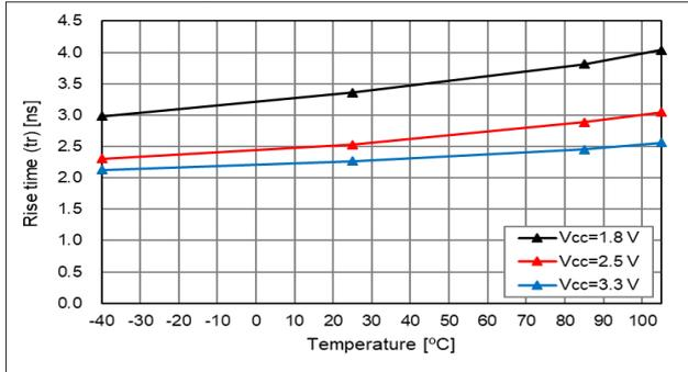
10% - 90% V<sub>CC</sub>, T<sub>use</sub> = +25 °C, 負荷(L<sub>CMOS</sub>)特性
