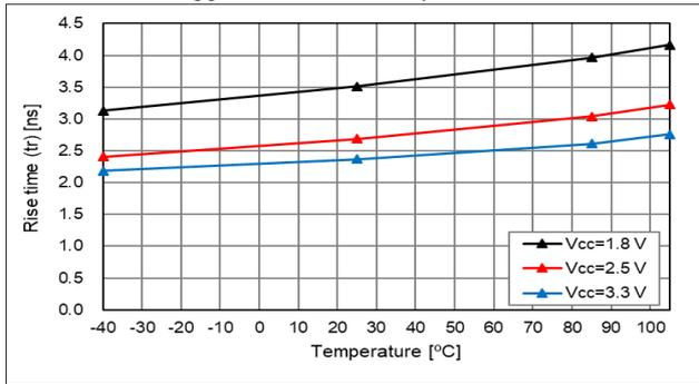
10 % - 90 %V<sub>CC</sub>, T<sub>use</sub> = +25 °C, 負荷(L<sub>CMOS</sub>)特性
