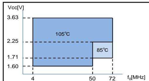
※電源電圧(V<sub>CC</sub>)は、出力周波数(fo)および動作温度上限(T<sub>use</sub> Max.)によって、対応可能範囲が異なりますので、ご注意ください
