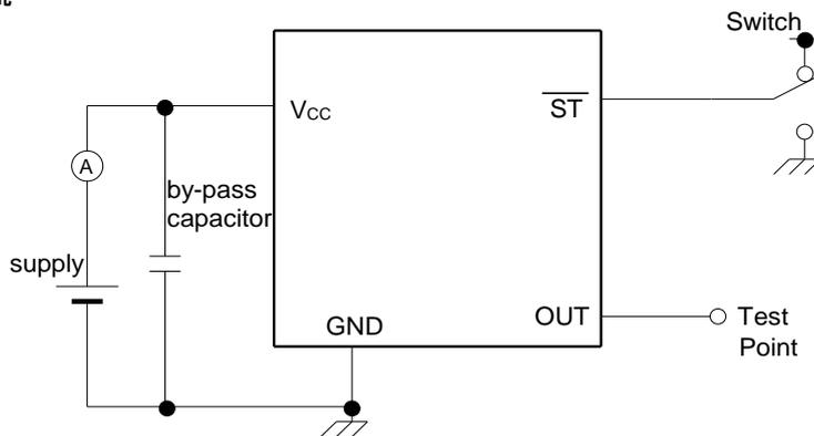
※スタンバイ時の消費電流は、 $\overline{ST}$ =GNDにする。
