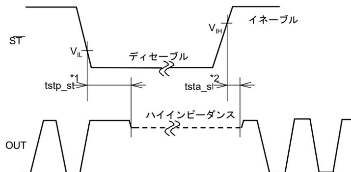
\*1 STが $V_{IL}$ になってから出力がハイインピーダンスになるまでの時間を示します。
