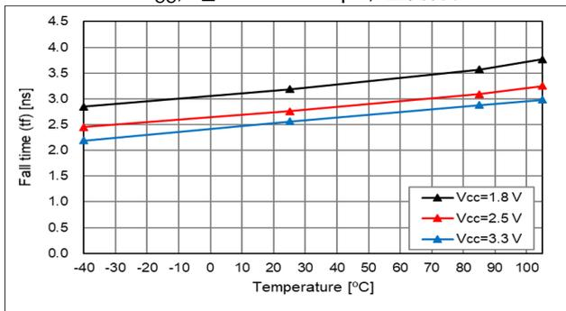
10 % - 90 %V<sub>CC</sub>, T<sub>use</sub> = +25 °C, 負荷(L<sub>CMOS</sub>)特性
