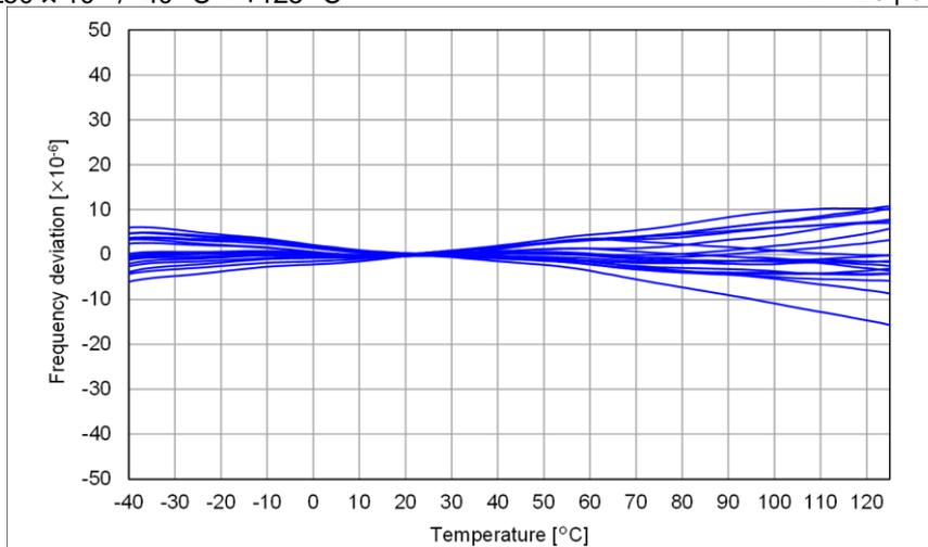
$\pm 15 \times 10^{-6} / -40 \text{ }^\circ\text{C} \sim +105 \text{ }^\circ\text{C}, \pm 25 \times 10^{-6} / -40 \text{ }^\circ\text{C} \sim +125 \text{ }^\circ\text{C}$
