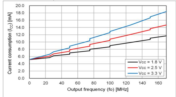
発振器の実消費電流は、発振器が動作するために必要な電流 (無負荷時消費電流) と、負荷駆動電流 ( $f_o \times L_{CMOS} \times V_{CC}$ ) の合計になります。システムの低消費電流化には、クロック周波数の低速化、電源電圧の低電圧化、負荷容量の削減が効果があります。
