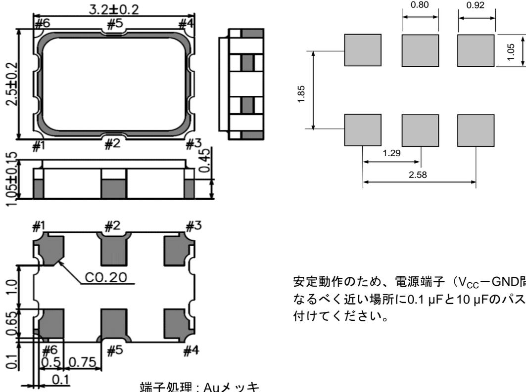
安定動作のため、電源端子 ( $V_{CC}$ -GND間) のなるべく近い場所に  $0.1 \mu\text{F}$  と  $10 \mu\text{F}$  のパスコンを付けてください。
