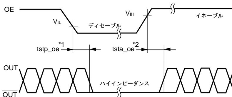
\*1 OEが $V_{IL}$ になってから出力がハイインピーダンスになるまでの時間を示します。
