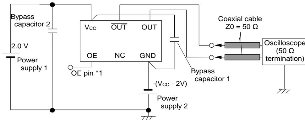
※OUT、 $\overline{\text{OUT}}$  端子の出カラインは、同じ長さにする。
