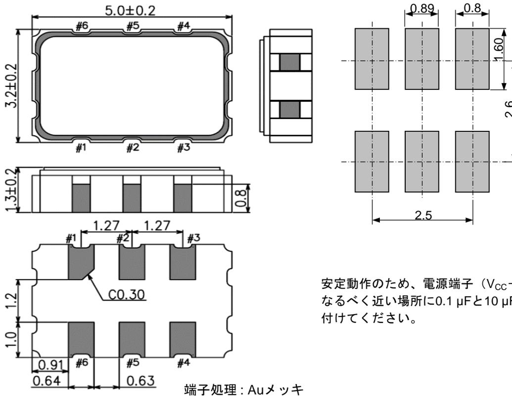
安定動作のため、電源端子 (V<sub>CC</sub>-GND間) のなるべく近い場所に0.1 μFと10 μFのパスコンを付けてください。
