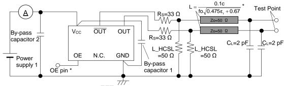
※OUT、ŌŪT 端子の出カラインは、同じ長さにする。 ※ディセーブル時の消費電流は、OE=GNDにする。
