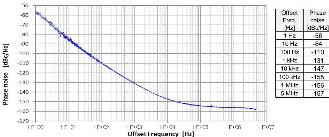
(6-9) 短期安定度  $T_{\text{use}} = +25 \text{ }^\circ\text{C}$
