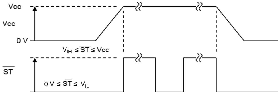
Standby制御と $V_{CC}$ 制御が同じ場合
