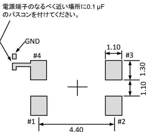
安定動作のため、電源端子 (V<sub>CC</sub> - GND 間) のなるべく近い場所に 0.1 μF のパスコンを付けてください。
