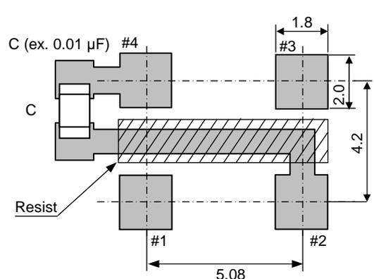
安定動作のため、電源端子 (V<sub>cc</sub>-GND 間) のなるべく近い場所に 0.01 μF ~ 0.1 μF のパスコンを付けてください
