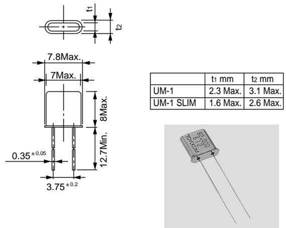
パッケージ外形寸法図〔単位：mm〕
